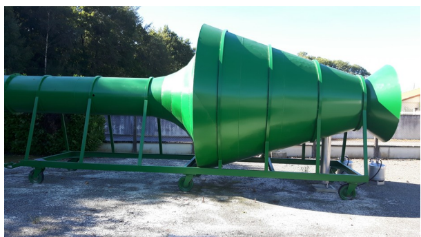
Wind tunel za ispitivanje aktivnosti reagensa AgI u dinamičkim uvjetima u Lannemezan-u u tehničkom sjedištu ANELFA
