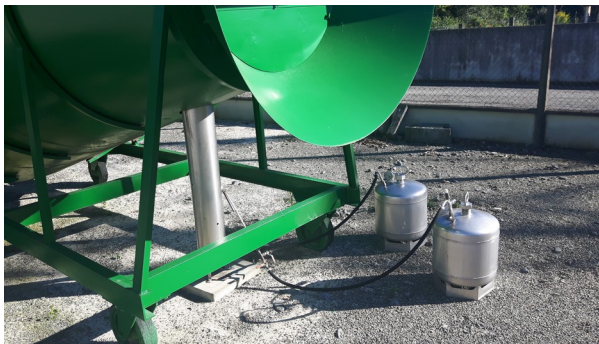
Wind tunel za ispitivanje aktivnosti reagensa AgI u dinamičkim uvjetima u Lannemezan-u u tehničkom sjedištu ANELFA
