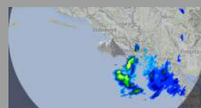
Radarska slika PPI radar x band Žarkovica, žuto i plavo pljusak nad morem povezan s kumulskim, sivo odraz valovi (smetnja).
