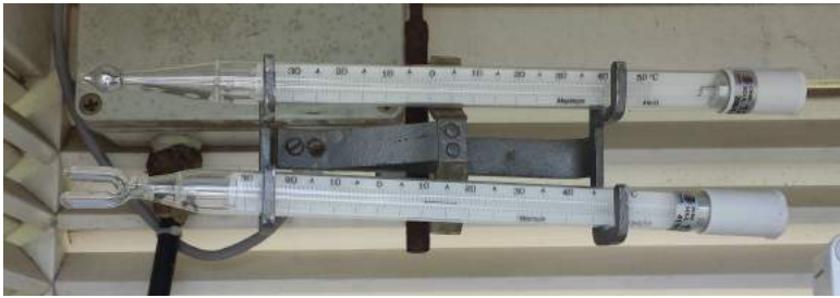
Maksimum i minimum termometri. (maksimum živin, minimum alkoholni)
